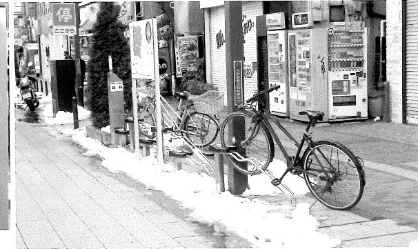
ステム「チャリコ」が採用されている。バッテリー内蔵のため電気工事が不要で、設置作業も床に固定するだけなので、設置コストが大幅に削減できる。
